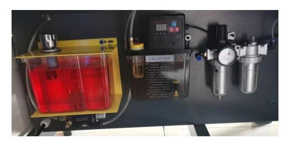
四、 接气:将8mm气管接入机床油水分离器内,打开气源。
